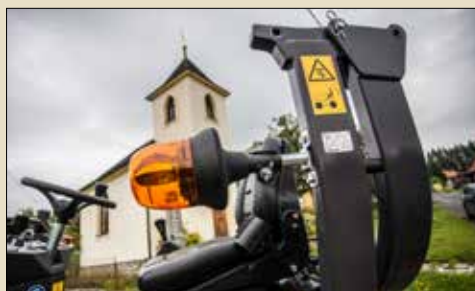
Structure ROPS pliable pour un transport facile
