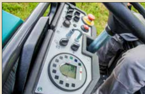
Un tableau de bord isolé des vibrations
